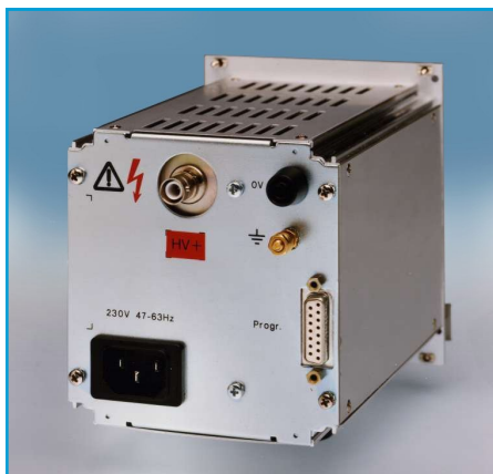
Rückseite mit Netzanschluss, Hochspannungsausgang und serienmäßiger Analogprogrammierung
