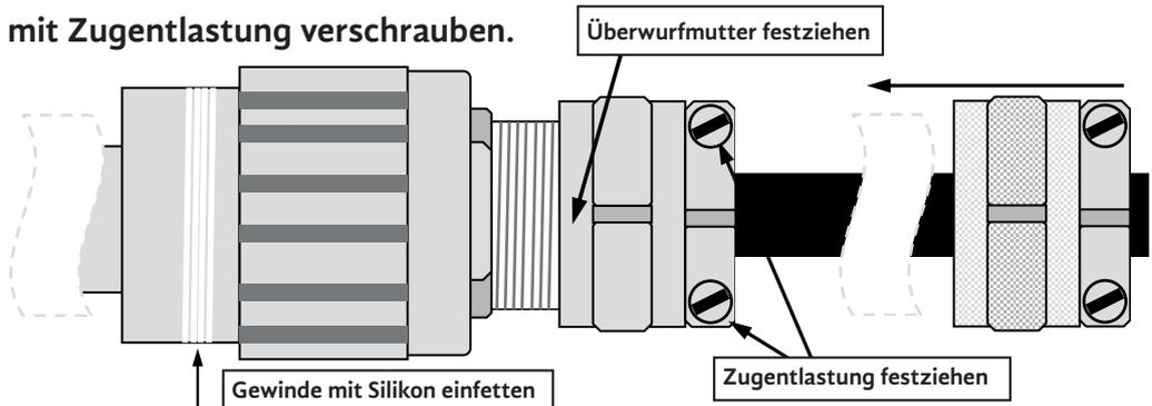
Diese Montageanleitung gilt sinngemäß auch für andere Stecker gleicher Bauart wie S130, HVS 65, HVS 100 oder HVS 150. Der Unterschied liegt nur in der Steckerlänge und dem Kabeldurchmesser.
