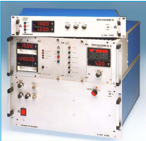
NTS 1200M - 10 10V / 120 A kundenspezifische Ausführung, mit Fernbedienungseinheit
