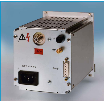
Rückseite mit Netzanschluss, Hochspannungsausgang und serienmäßiger Analogprogrammierung
